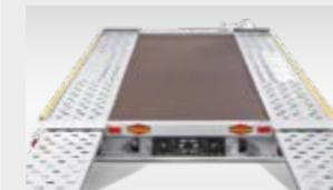
**Siebdruckbodenplatte** für eine geschlossene Oberfläche. Ideal zum Transport von Fahrzeugen, die Flüssigkeit verlieren.
