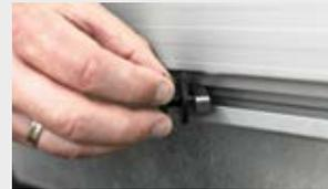
**Flexible Netzhaken** vereinfachen die Platzierung des Ladungs-sicherungsnetzes entlang der Bordwand (Zubehör).
