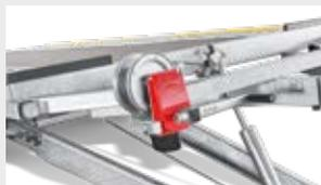
**Windebock & Winde** Der massive Windebock mit Seilwinde und 3-fach verstellbarer Umlenkrolle.
