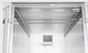
**Ankerschiene und Absperrstange** zur Sicherung des Transportguts.
