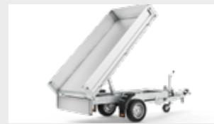
**Kombiboden** Durchgehende Siebdruckbodenplatte mit Stahlblechbodenplatte für Stoßunempfindlichkeit (bei Profi-Modellen Grundausstattung).
