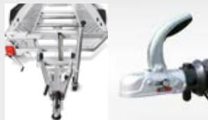
**V-Deichsel & Anhängungs** Robuste, geschraubte V-Deichsel und massive Gusskupplung (nur bei 3500 kg Ges.-Gew.).
