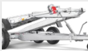
**Hebesystem** Hydraulisches Sicherheits-Hebesystem mit zeitsparendem Schnell-Ladesystem.
