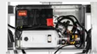
**Elektrische Hydraulikpumpe** mit Batterie und Nothandpumpe (bei Profi-Modellen Grundausstattung).
