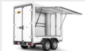
**Aufstellklappe** für KT- und KH-Modelle erhältlich (außer KTP-Modelle).
