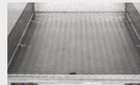
**Iso-Boden mit Alu-Riffelblech** bietet eine zusätzliche Isolierung für den Anhänger.
