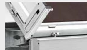
**Neues Scharnierprofil** ist vor herabfallendem Schmutz geschützt und durch die **neue Bordwandkonstruktion** lässt sich die Ladung nahezu verlustfrei transportieren.
