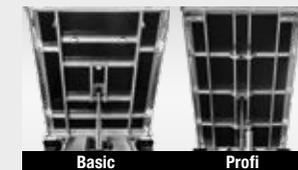
**Massive Stahlprofilbrücke** Serienm. feuerverz. Ober- und Unterbrücke (außer RK-AL 2514/15).
