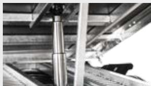
**Sicherungsstütze** Zur Fixierung der Oberbrücke, so wird ein plötzliches Absinken verhindert (außer RK-AL 2514/15).
