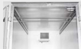
**Ankerschiene und Absperrstange** zur Sicherung des Transportguts.
