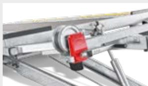
**Windenbock & Winde** Der massive Windenbock mit Seilwinde und 3-fach verstellbarer Umlenkrolle.
