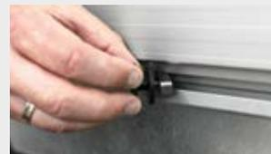
**Flexible Netzhaken** vereinfachen die Platzierung des Ladungs-sicherungsnetzes entlang der Bordwand.
