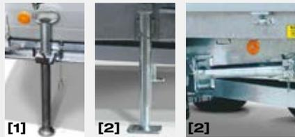
**Doppelt hält besser:** Entscheiden Sie sich für ausziehbare Schiebstützen [1] oder für schwenk- und ausdrehbare Teleskopkurbelstützen [2].
