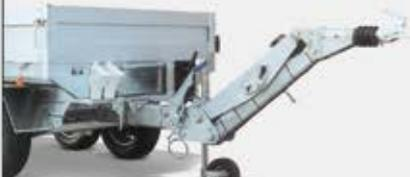
**Steigen Sie auf:** Mit der höhenverstellbaren Auflaufeinrichtung für LKW-Zugfahrzeuge.
