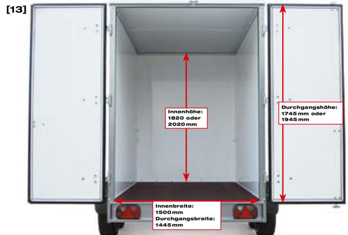
**Für alle, die mehr möchten:** Je nach gewünschter Transportaufgabe stehen Ihnen Koffernhänger-Modelle mit einer Innenhöhe von 1520, 1820 oder 2020 mm zur Verfügung. Alle Modelle mit einer Breite von 1300 mm (Durchgangsbreite 1245 mm) und einer Innenhöhe von 1520 mm sind mit einer 1-Flügel-tür, alle Modelle mit einer Innenhöhe von 1520, 1820 oder 2020 mm und einer Breite von 1500 mm (Durchgangsbreite 1445 mm) sind mit einer 2-Flügel-tür ausgerüstet.
