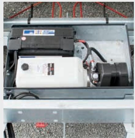
**Zeit ist Geld:** Die elektrische Hydraulikpumpe mit Nothandpumpe (Zubehör, siehe S.13) für das schnelle und bequeme Abladen von Schüttgütern.
