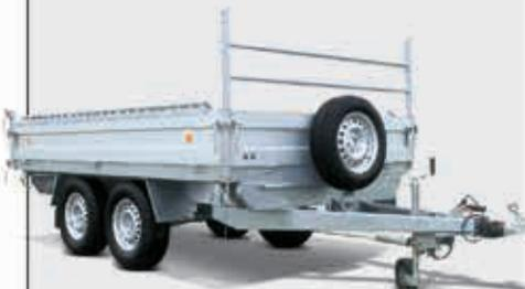
**Sicher ist sicher:** Die Stirnwandgalerie erhöht die Transport- und Fahrersicherheit – insbesondere bei hochstehenden Transportgütern.
