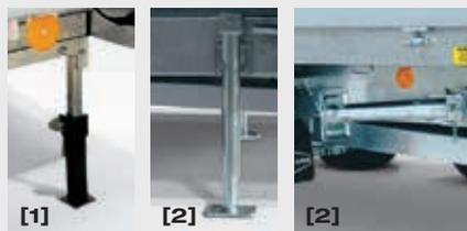
**Doppelt hält besser:** Entscheiden Sie sich für die Linnepe-Stützen [1] oder die schwenk- und ausdrehbaren Teleskopkurbelstützen [2].
