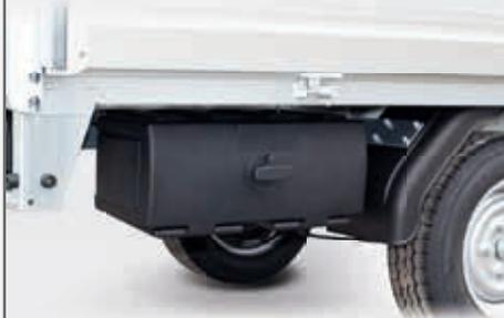
**Stauraum für wichtige Utensilien:** Der abschließbare Staukasten ist mit 440 x 150 x 210 mm und einer max. Beladung von 20 kg sehr geräumig (für die Modelle RK-AL 2514, DK-AL 3218 und DK-AL 3718 lieferbar).
