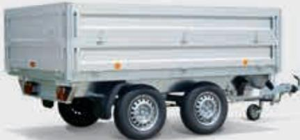
**Mehr Platz:** Der eloxierte Aluminium-Kastenaufsatz erhöht die Bordwände und verdoppelt das Ladevolumen.
