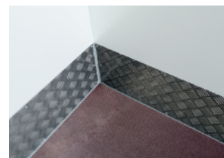
Scheuerschutz innen auf Stirn- und Seitenwänden
