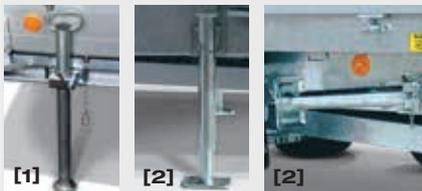
**Doppelt hält besser:** Entscheiden Sie sich für ausziehbare Schiebstützen [1] oder für schwenk- und ausdrehbare Teleskopkurbelstützen [2].
