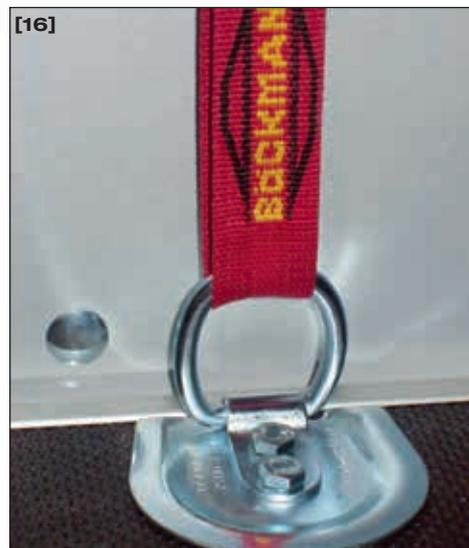
**Sicher unterwegs:** Die Verzurrösen sind fest mit der Siebdruckbodenplatte verschraubt und ermöglichen eine optimale Sicherung der Ladung (Maximale Zugkraft von 250 kg).
