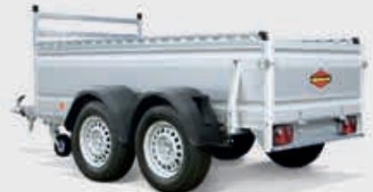
**Mehr Platz:** Mit der Bordwanderhöhung auf 560 mm (bis 1160 mm möglich) erhöhen Sie das Ladevolumen.
