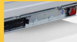
Klappe Verhindert das Herausrutschen der unterschiebbaren Auffahrschienen
